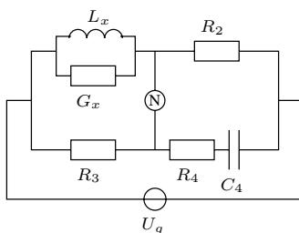
Az ábrán látható ún. Hay-híd induktivitás párhuzamos helyettesítőképét ( $L_x, G_x$ ) méri. Az állítható elemek  $R_4$  és  $C_4$ ,  $R_2 = R_3 = 1$  k $\Omega$ .
