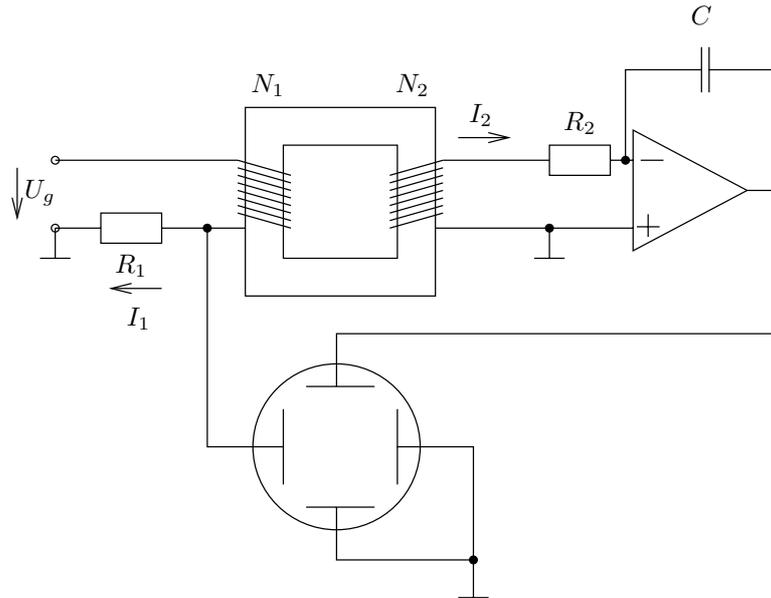
A tekercs alatt a katódsugárcső eltérítését ábrázoltuk. Előnyös a toroid alakú vasmag, az ábrázolás egyszerűbbé tétele miatt nem ezt rajzoltuk fel. (1 pont)
