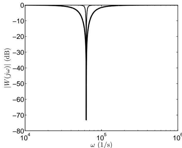
A törésponti körfrekvencia számszerű értéke:  $\omega_0 = 6.3246 \cdot 10^4 \frac{1}{s}$ . A hálózat ún. lyukszűrő, olyan sávzáró szűrő, amelynek zárósávja egyetlen frekvenciára korlátozódik. A példában megadott adatokhoz a vastagabb vonallal rajzolt, szélesebb karakterisztika tartozik.
