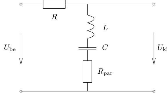
Mind a tekercs, mind a kondenzátor vesztesége figyelembe vehető soros ellenállás formájában, ezek eredője az ábrán az  $R_{par}$  parazita ellenállás. Ennek a módosított hálózatnak az átviteli függvénye a (13) egyenlet alapján:
