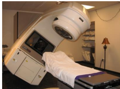
1985 és 1987 között a Therac-25 számítógép-vezérelt sugárterápiás készülék súlyosan (~100-szoros dózis) túlterhelt hat páciens.
