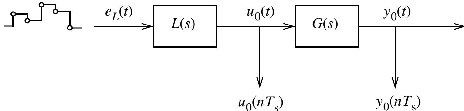
$$G_1(z^{-1}) = \frac{Z\{y_0(nT_s)\}}{Z\{u_0(nT_s)\}} = \frac{\frac{Z\{y_0(nT_s)\}}{Z\{e_L(nT_s)\}}}{\frac{Z\{u_0(nT_s)\}}{Z\{e_L(nT_s)\}}} = \frac{(1 - z^{-1})Z\{L^{-1}\{L(s)G(s)/s\}\}}{(1 - z^{-1})Z\{L^{-1}\{L(s)/s\}\}}$$
