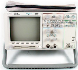
Oscilloscope (DC - 100MHz) Agilent 54622A
