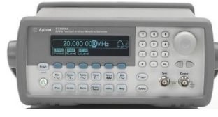
Function generator ( < 20\text{ MHz} ) Agilent 33220A
