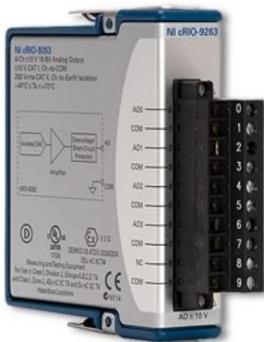
3. ábra. Az NI 9263 DA modul fizikai megjelenése.
