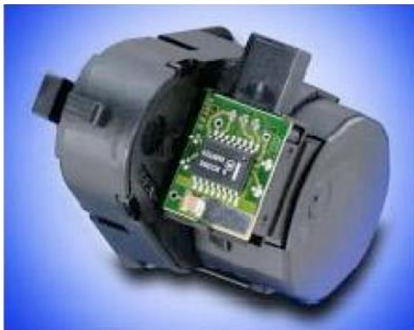
2.2 ábra. Egy LIN slave egység közvetlenül a beavatkozóba integrálva (illusztráció)
