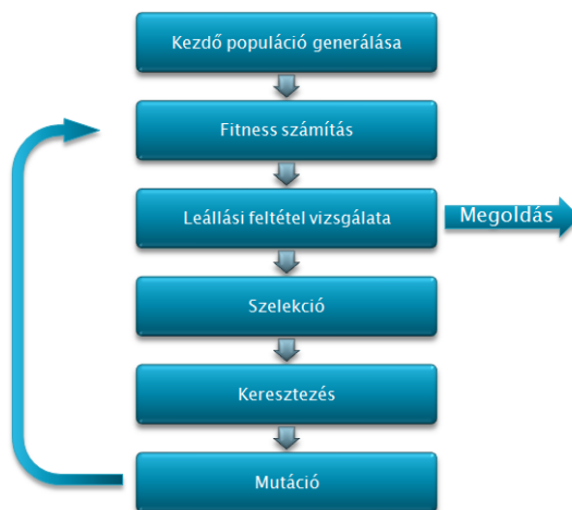
1. ábra: genetikus algoritmusok felépítése
