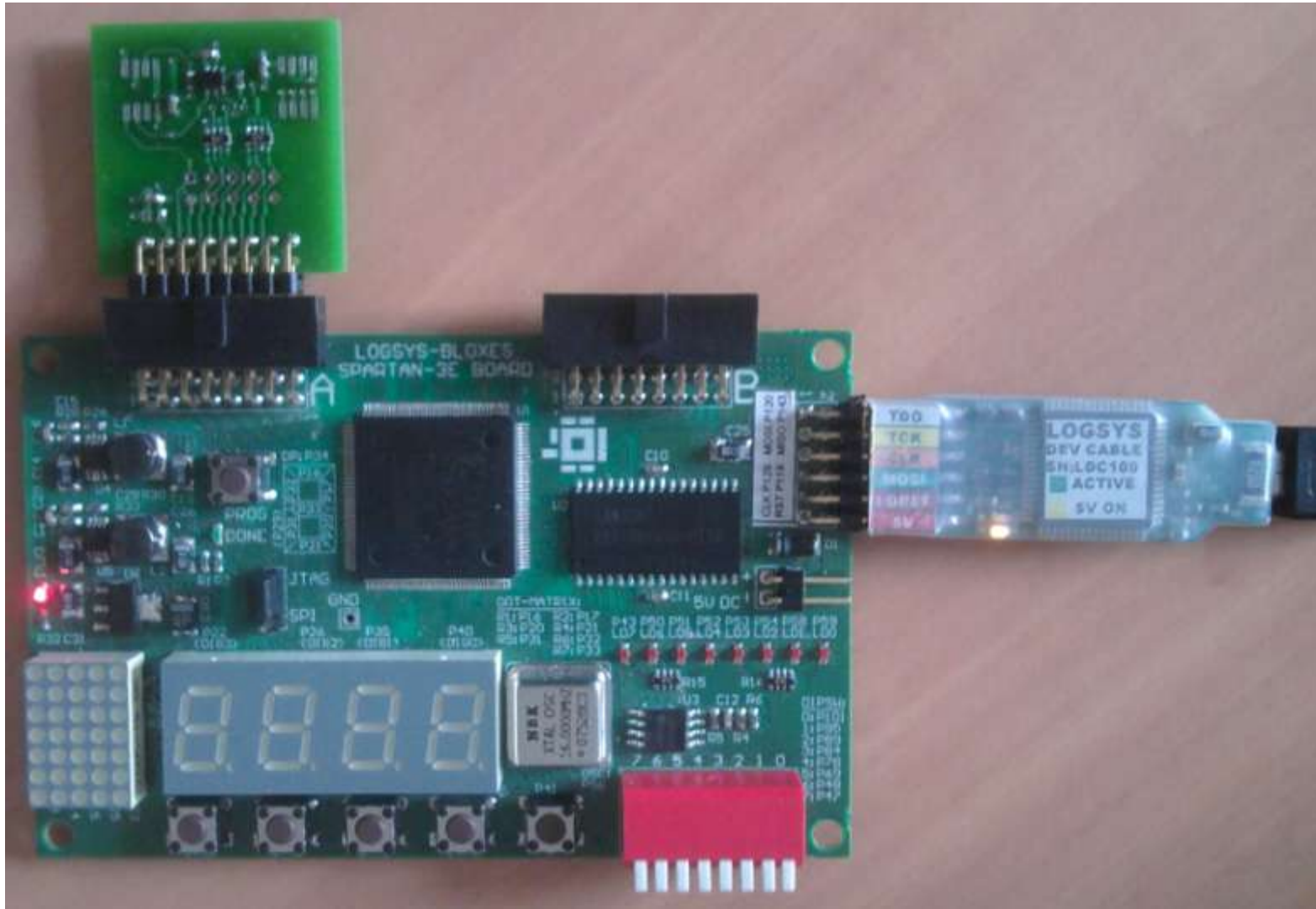
A fejlesztői kártya, az USB adapter és a hőmérő modul helyes csatlakoztatása
